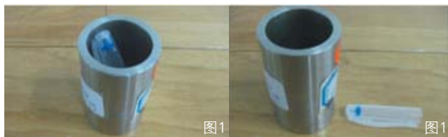
图1：小部件圆筒及模拟小部件的圆珠笔笔盖
