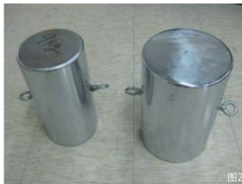
图2：左为模拟6个月以下儿童的9kg重物，右为模拟6个月以上儿童的15kg重物
